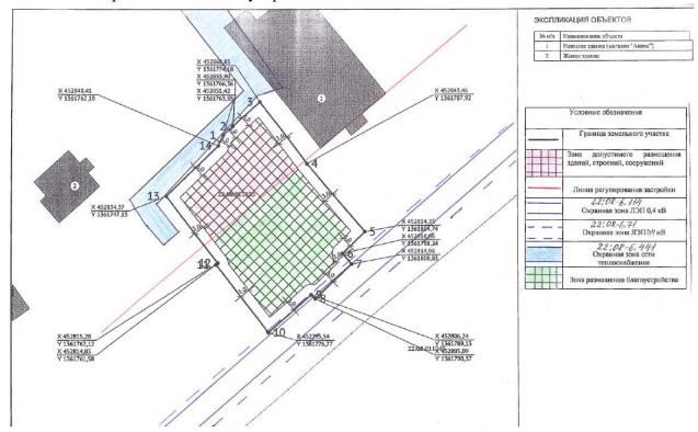
Здание площадью застройки — 750 кв.м. выходит за границу «Зона допустимого размещения зданий, строений, сооружение» и частично располагается на «Зона размещения благоустройства».
